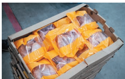
Рис. 2. Упаковка куриной разделки в пакеты с модифицированной газовой средой
