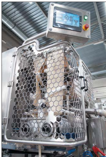
Рис. 1. Пельменный автомат модели АП1100 с производительностью до 1100 кг/ч
