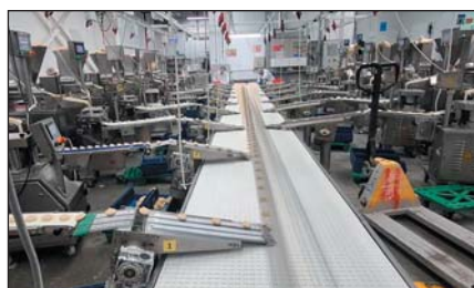
Рис. 4. Участок из 12 автоматов «Экстро Макс» по производству хинкали (общая производительность – 4200 кг/ч)
