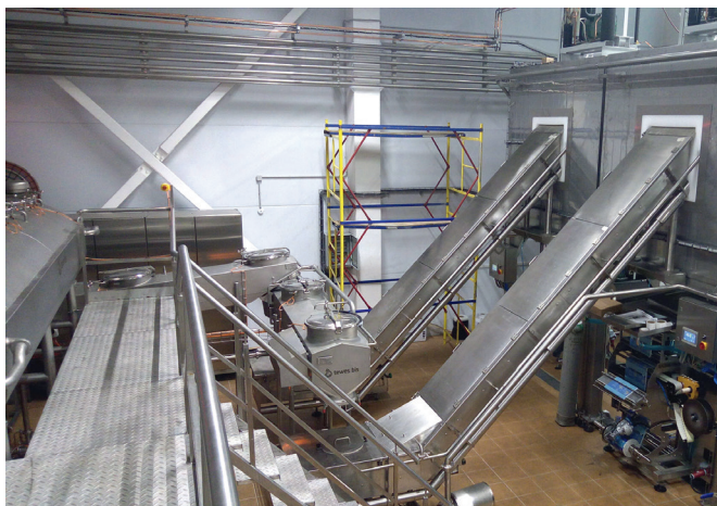
Рис. 5. Защищенный тракт подачи продукта с закрытой зоной дозирования
