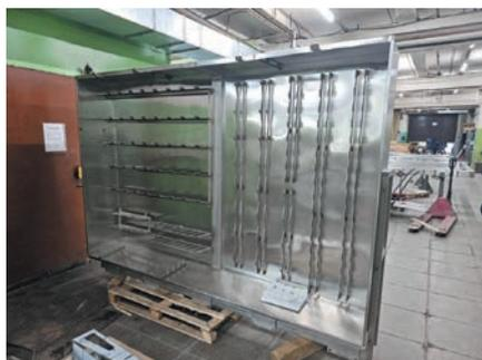
Рис. 2. Сдвоенный шкаф для мойки
