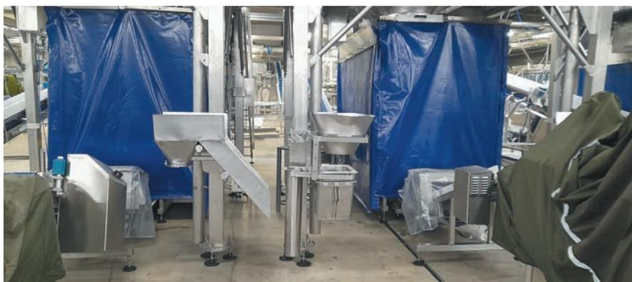
Рис. 5. Упаковочные линии, разобранные для мойки. Чехол для упаковочной машины
