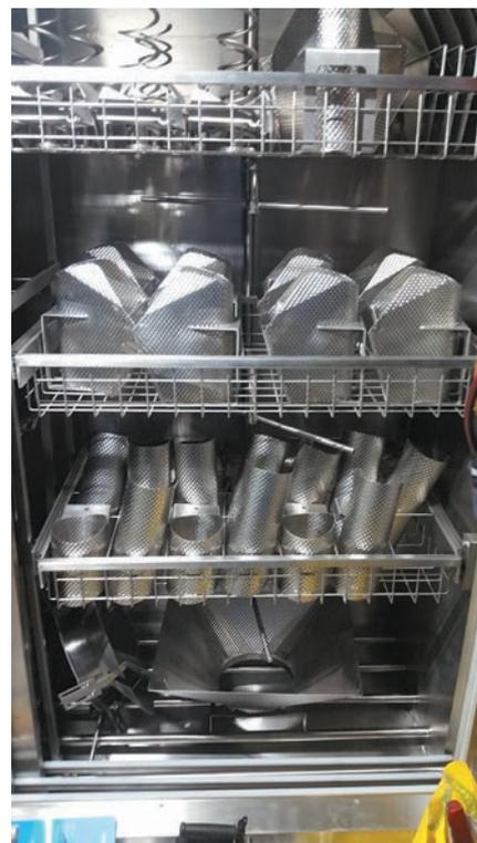
Рис. 3. Шкаф мойки с деталями дозатора для санитарной обработки
