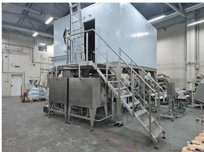
Рис. 7. Сдвоенная упаковочная линия с камерой охлаждения и интегрированной системой мойки
