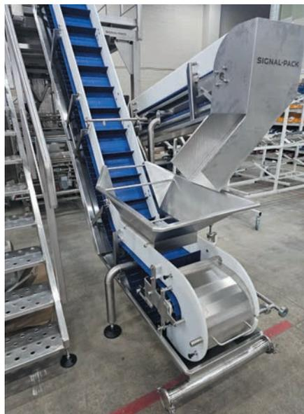
Рис. 4. Транспортер с интегрированными форсунками для подключения к системе мойки
