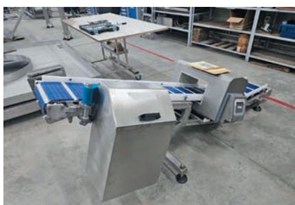
Рис. 6. Гигиеническое исполнение металлодетектора
