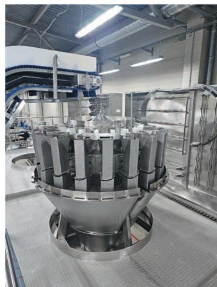
Рис. 1. 20-карманный комбинационный дозатор в гигиеническом исполнении
