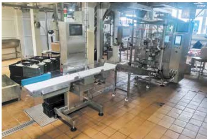
Рис. 1. Линия по упаковке творога в пакет (сектор упаковки и контроля веса) производства «Сигнал-Пак»
