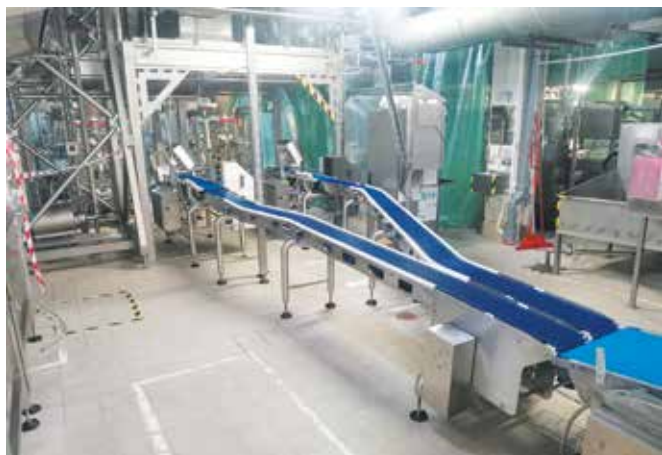
Рис. 3. Сдвоенная линия по упаковке творога производства «Сигнал-Пак»
