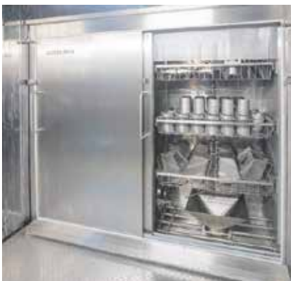
Рис. 6. Машина моечная «Сигнал-Пак» для мойки деталей дозатора
