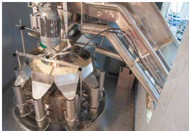
Рис. 4. Весовой мультиголовочный шнековый дозатор для творога «Сигнал-Пак»
