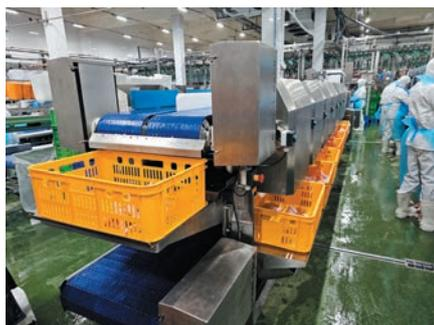
Рис. 2. Динамическое взвешивание и сортировка продукта на грейдер-сортировщике
