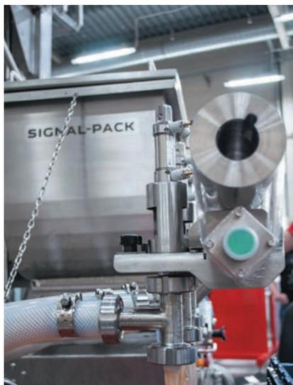
Рис. 8. Жидкостный дозатор для маринада на линии фасовки шашлыка
