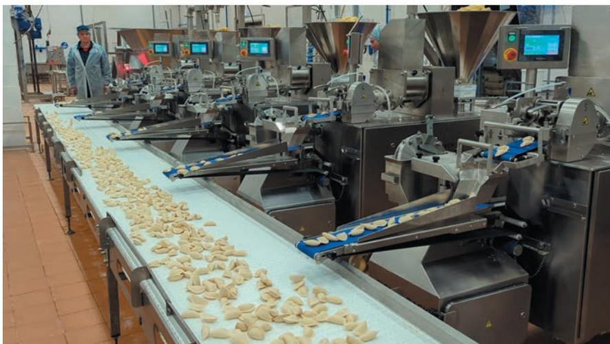
Рис. 3. Линия из шести автоматов «Экстро Макс» с производительностью 2 т полуфабрикатов в час и частотой загрузки сырья каждые 20 мин
