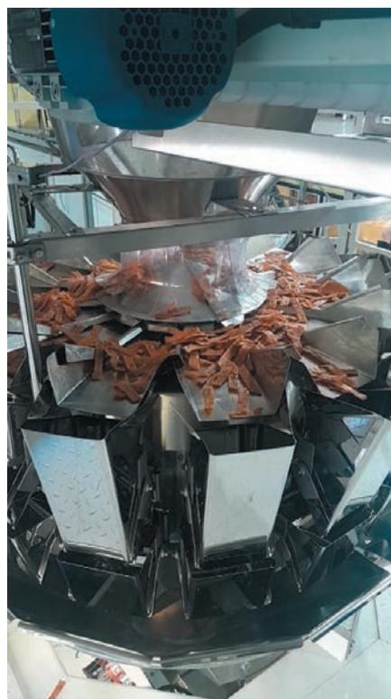
Рис. 1. Дозирование мясных снеков. Реализована функция отведения дозы из-за сложной формы продукта
