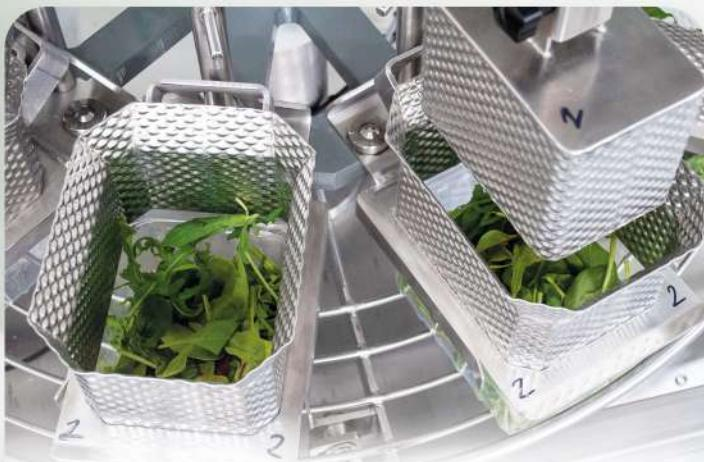
Конструкция раскладчика коррексов предусматривает работу на двух различных форматах. Переход с одного формата на другой прост и занимает не более 15 минут.
