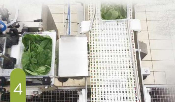
Благодаря автоматизации большей части технологических процессов, Заказчик смог высвободить трудовые ресурсы для других производственных нужд. Оборудование изготовлено из пищевой нержавеющей стали и имеет высокую степень защиты от воды и моющих растворов, благодаря чему легко моется.
